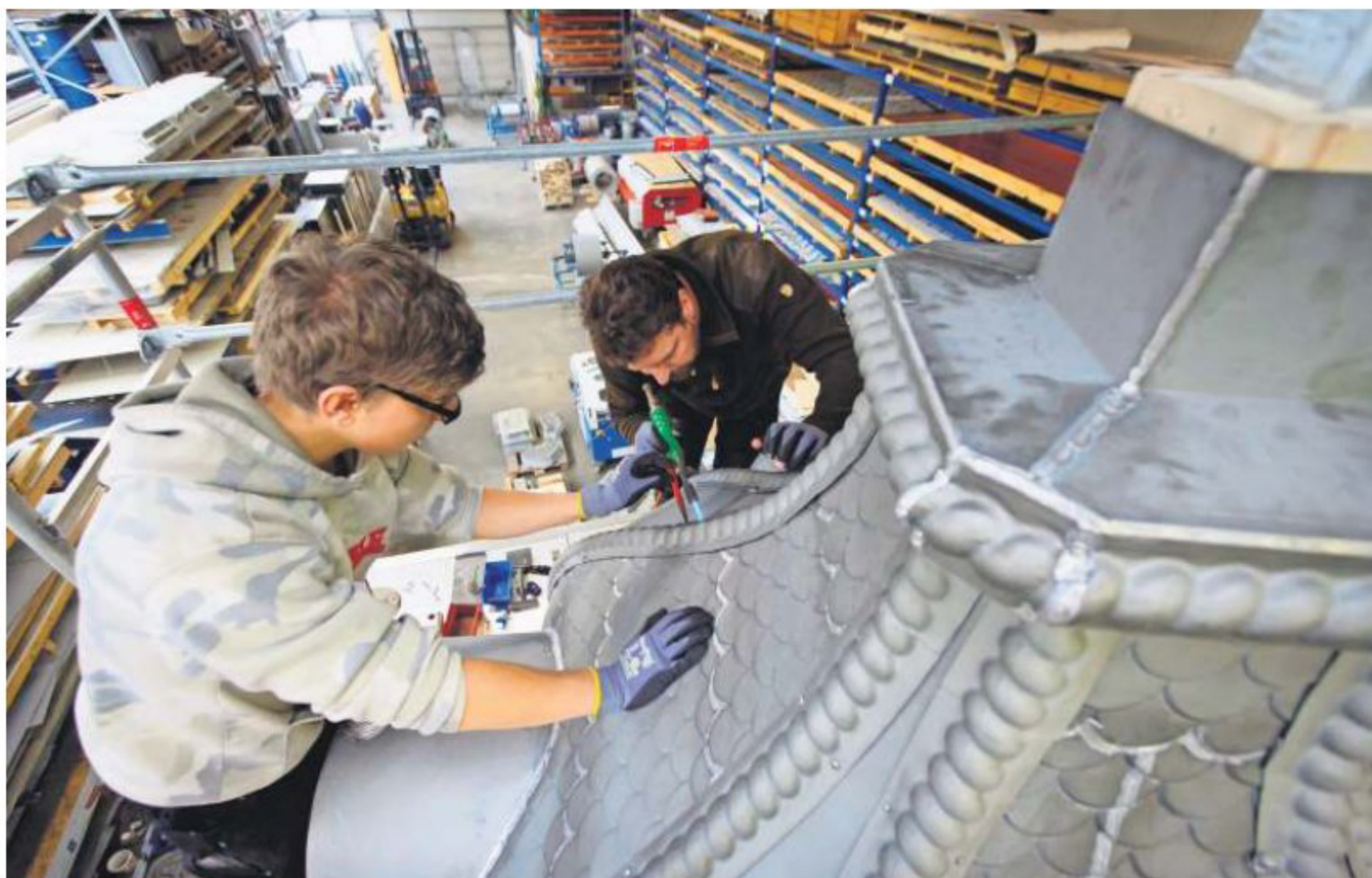
Michael Messerschmidt kümmert sich mit Lehrling Leon Luck (links) und die Hauerbuckel: Sie verlöten Schraubenköpfe mit Hütchen aus Blech.
